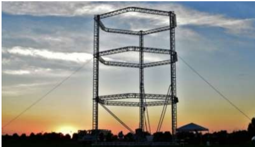
Рисунок 4.12 – 3D-принтер компанії WASP (висота 12 м, діаметр – 6 м) (Загорская, 2015 а)
