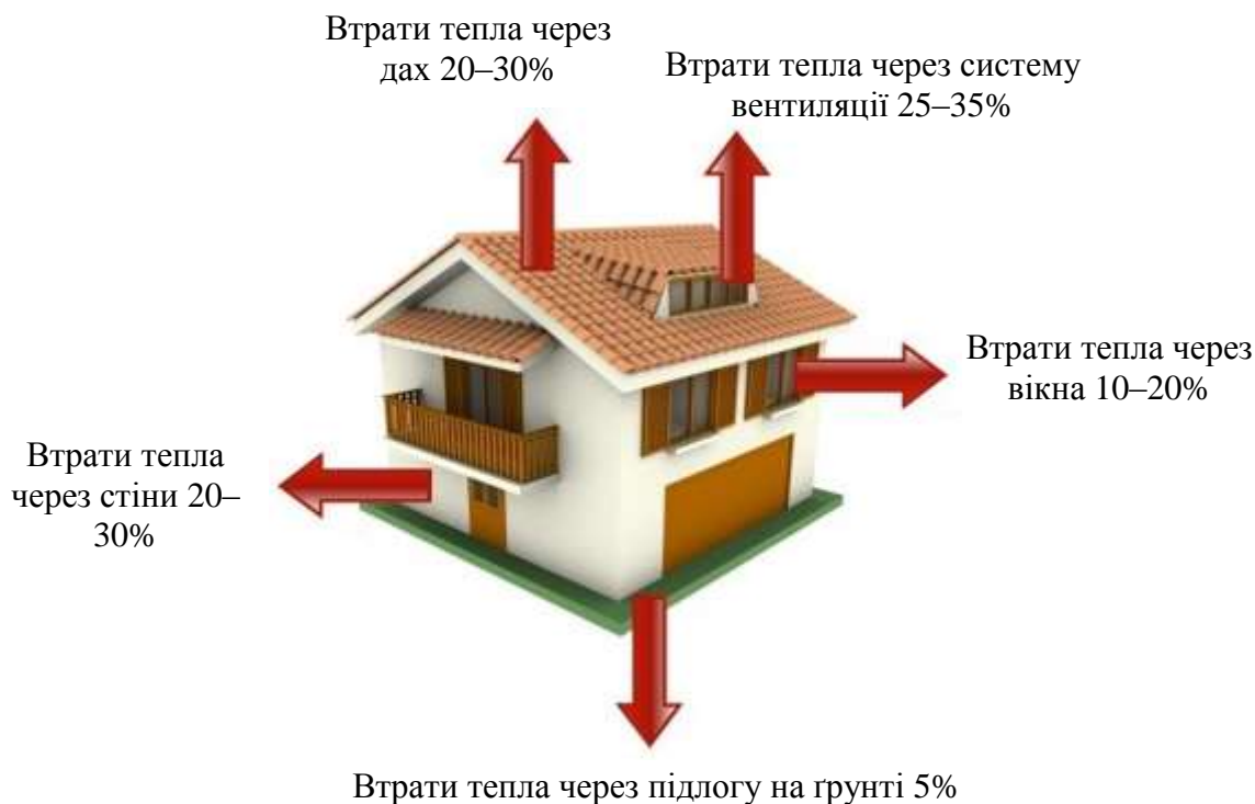
Рисунок 9.1 – Частки тепловтрат у будинку (Расчет, 2017; Как приходит, 2017; Энергоэффективный, 2017)
